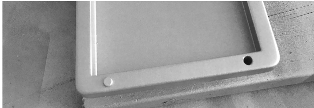
Hål borrar för nedsänkning av magneterna.
